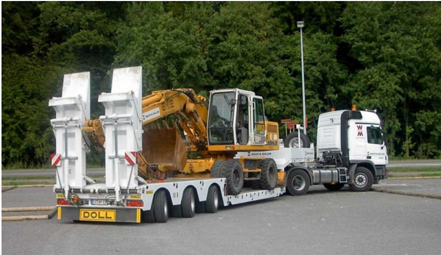
VARIO-3-Achs- Tiefbett-Sattelaufzieger, Typ T3H , mit Auffahrampen
