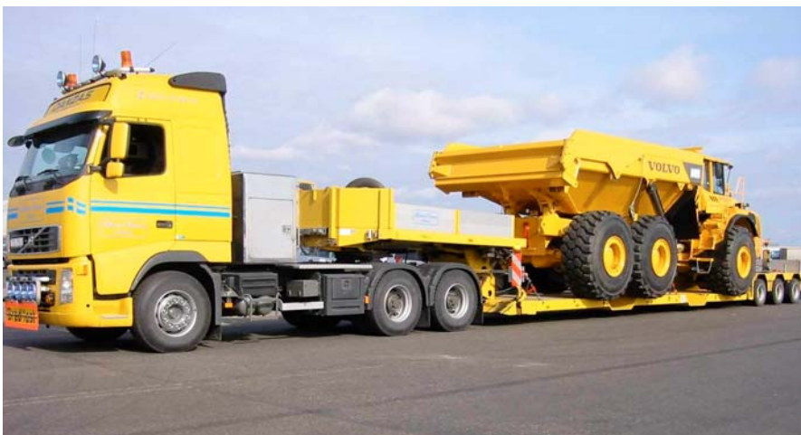
VARIO – Dreiachs- Tieflade-Sattelaufzieger mit abfahrbarem Schwanenhals, Typ T3H-S3
