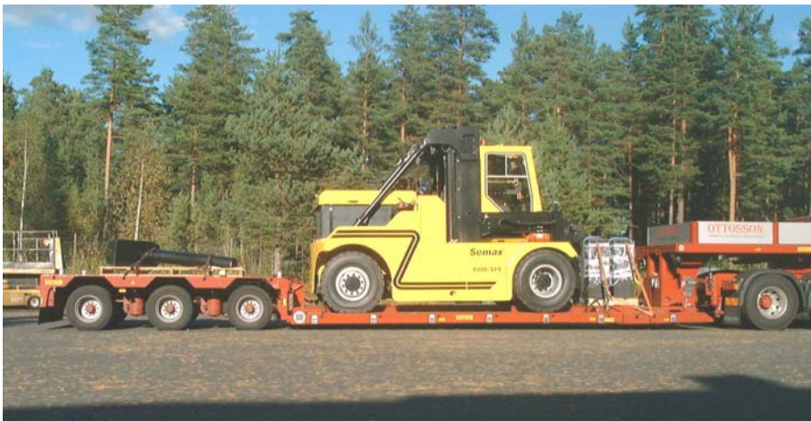
VARIO – Dreiachs- Tieflade-Sattelaufzieger mit abfahrbarem Schwanenhals, Typ T3H-S3
